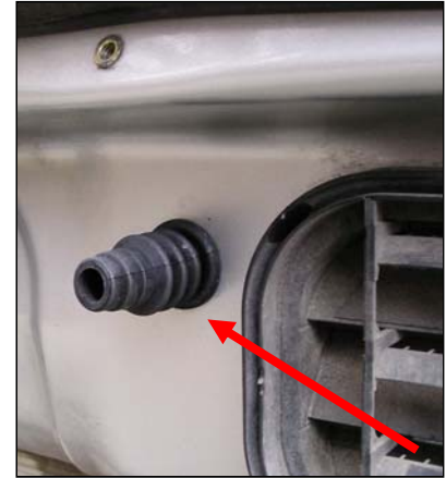
Kabelausführung aus der Heckschürze
