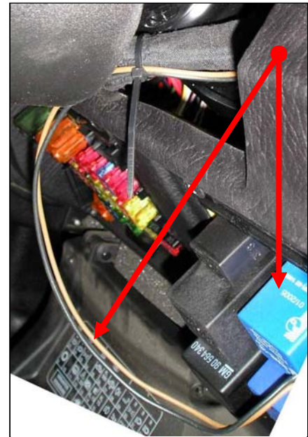
neues Relais und Kabelverlegung
